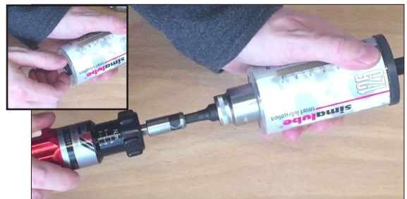
Parafusar o gerador de gás e apertar com 1,5-2,0 Nm
