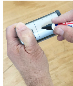
Marcar o tipo de graxa e a data de início de operação
