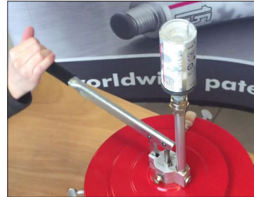
Encaixar o simalube no bico da bomba de graxa e bombear devagar até atingir a marca superior.
