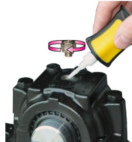
Enroscar o bico de redução (se necessário, selar o ponto de lubrificação)
