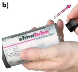
b) Remova o gerador de gás com uma chave de porcas (SW21mm)
