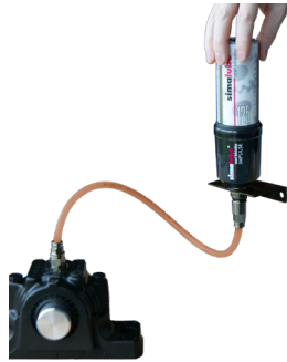
Enroscar o novo lubrificador no ponto de lubrificação
