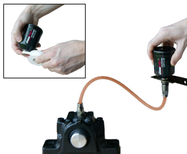
Sele o IMPULSE e enrosque no ponto de lubrificação i logótipo IMPULSE deve ficar virado para a frente
