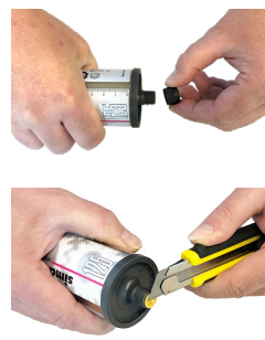
Cortar a tampa do lubrificador ou remove a tampa preta
